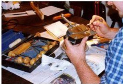
Die beiden Hälften einer Schieferform werden zuerst aufwändig plangeschliffen, damit die Figur später keinen Grat hat und dann mit eingegossenen Paß-Stiften arretiert damit sie sich später nicht mehr verschieben können. Erst dann wird der Umriss der Zeichnung auf den ersten Formenstein übertragen
